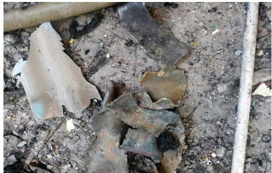
图3 部分管道粉碎性破裂
