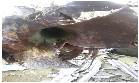
图2 放料管道撕裂变形
