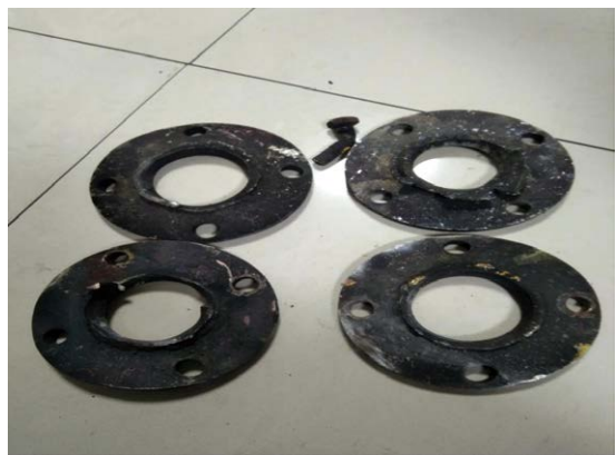
图4 两对法兰连接管道断裂
