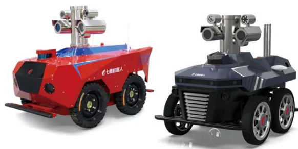
防爆化工轮式巡检机器人普通版（左）和高性能版（右）
