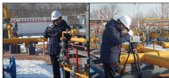
图 5 中国石油某天然气站的现场手持式、固定式泄漏检测
