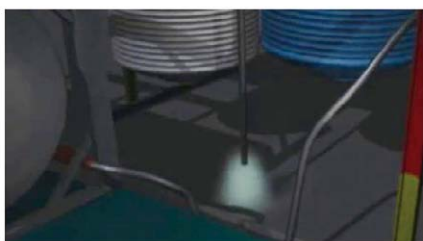
图2. 工艺区域附近低点位置泄漏的工艺蒸气
