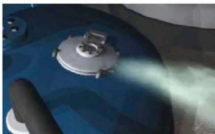
图1. 通过人孔泄漏的工艺蒸气
