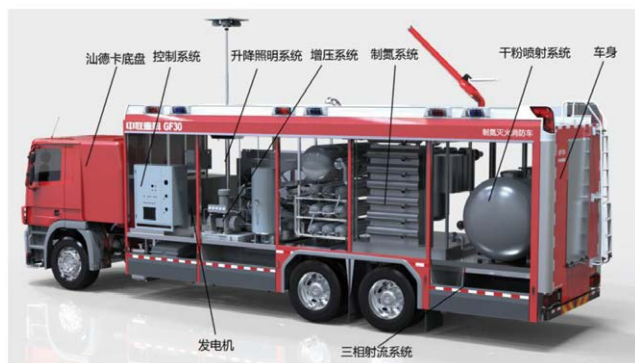
图 4 制氮灭火消防车结构
