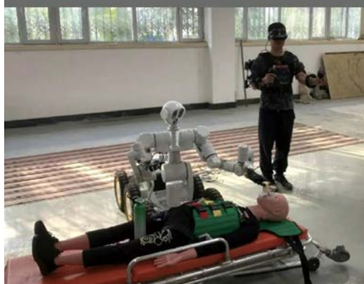
图2 双臂急救处置机器人系统
