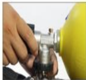
1、将气瓶阀门和减压器阀门连接
