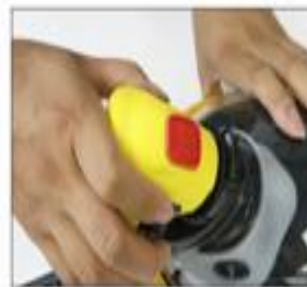
2、将供气阀安装在面罩卡口处
