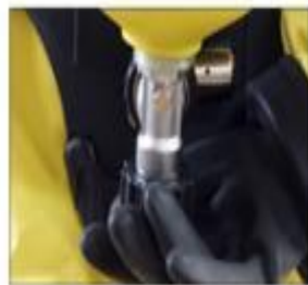
7、逆时针打开气瓶阀门 呼吸顺畅后进行作业
